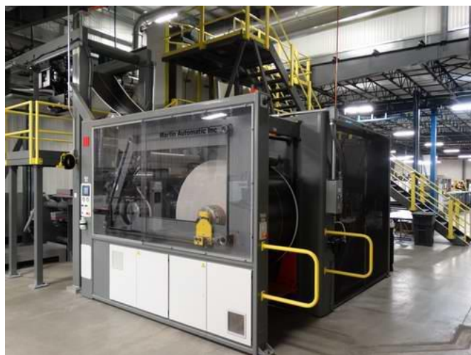
图 3: 马汀 LRH 不停机自动收卷机，通过转向装置与印刷机成直角安装
