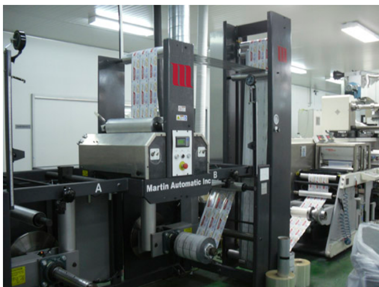
图 1：马汀公司 MBS 自动放卷机安装于 Nilpeter 印刷机，每天可以增加 30% 产能
