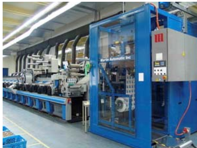
图2: 马汀全自动LRD收卷机
